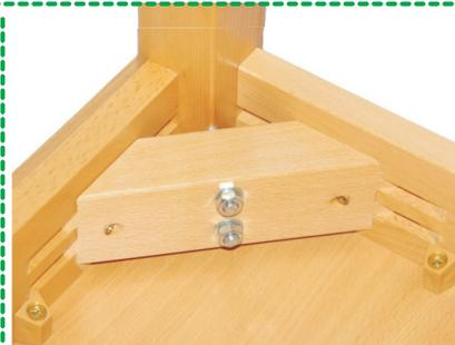
Unsere Tischbeine werden mit doppeltem Verbindungsbolzen fest in die Zargenecke hineingezogen. In Verbindung mit der fest verleimten Knaagge (eine Technik aus dem Fachwerkbau) ergibt eine sichere und sehr stabile Eckverbindung\*. Die auswechselbaren Tischbeine bringen einen weiteren Vorteil, der Tisch kann mitwachsen! Einfach höhere Tischbeine nachbestellen! \* Achtung die Tischverbindung kann je nach Tischvariante variieren. (Holz/Metall oder keine, falls die Tische komplett verleimt sind).
